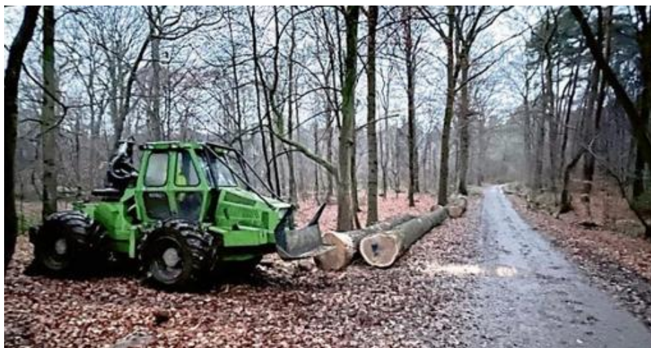
Am Haupt-Querweg steht der Harvester oder Vollernter.
